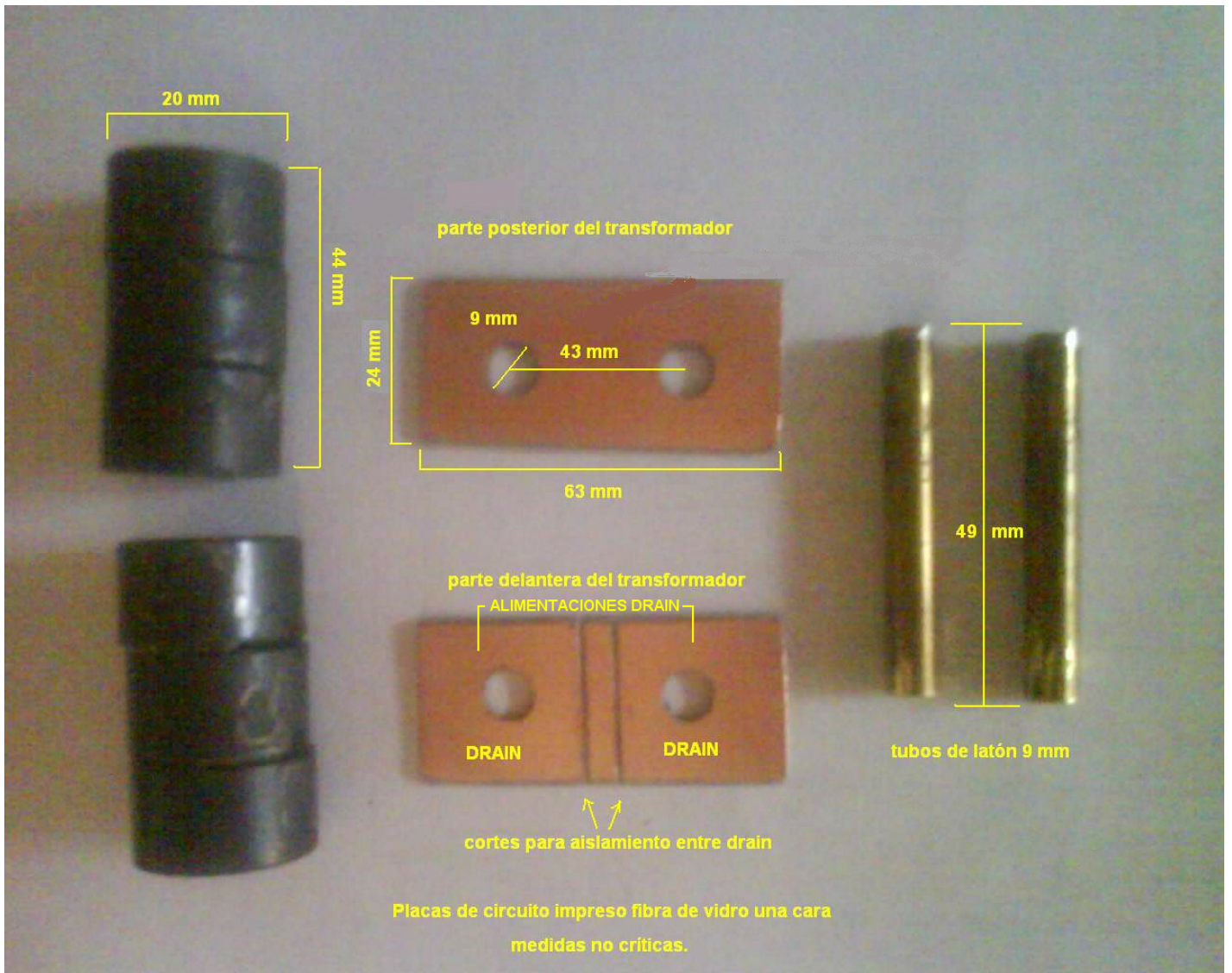
Fig 3 y 4: Detalles del choque de alimentación T-2 y del transformador de salida
